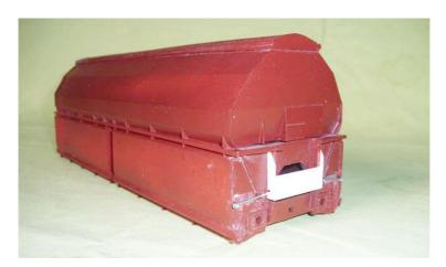
Auf die Stirnseite wird weiter der Messing Schwenkdach Mechanismus geklebt.
