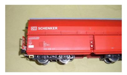
Zum Schluss werden die Kupplung und die Puffer montiert.
